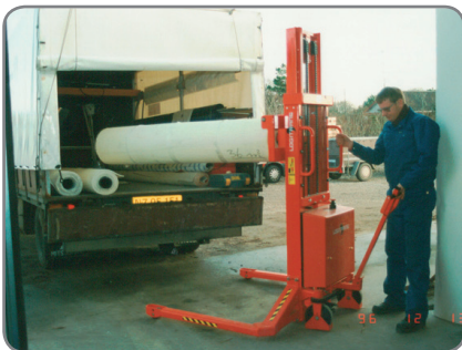
Een spreidstand Logiflex kan ook rollen behandelen die op de grond staan.
