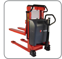
Bij het gebruik van een Logiflex zonder spreidstandpoten moet de rol op een palet liggen.
