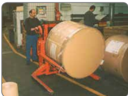
De vorken geschikt voor het nemen van vaten of bobijnen hier in gebruik in de verpakingsindustrie.
