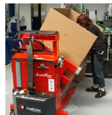
Optimale werkomstandigheden: De gebruiker kan de bodem bereiken zonder strekken of rugpijn.
