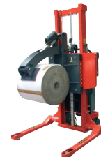
Met de Rotator Rollenkleem kunnen zware rollen verplaatst, gehoffen en gekanteld worden tot 90° naar beide kanten.
