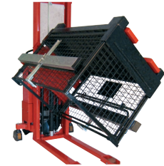
De Rotator kan een box 180° draaien om deze volledig te ledigen, indien er boxhouders met klemmen voorzien zijn.
