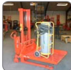
Het platform dient hier voor het verplaatsen van een vacuümreiniger.
