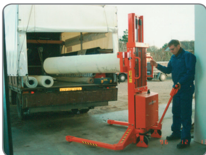
Un Logiflex con patas ajustables cargando un camión de bobinas.
