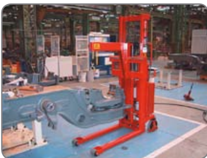
Brazo grúa trabajando en una fábrica de componentes ferroviarios.
