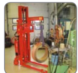
Elevando bobinas metálicas a una máquina de perforar.
