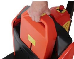
Lichtgewicht (slechts 5,2 kg) Lithium batterij van hoge kwaliteit, gemakkelijk te vervangen.
