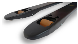
Op 800 mm markering op de vorken om beschadiging van paletten tegen te gaan bij het dwars nemen van paletten. Stabiliteitswielen en inrijwielen.
